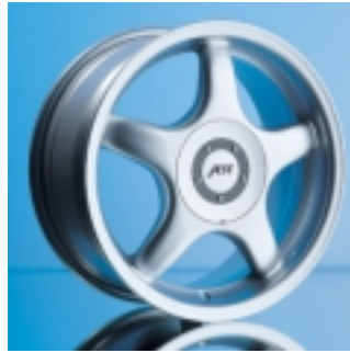
Abt Sportfelge A13 7 x 16 ET 35 einteilig, gegossen.
