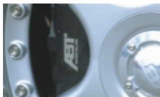
Abt Sportbremsanlage Vergrößerte Bremsscheiben, 4-Kolben-Bremssättel (nur in Verbindung mit Abt Sportfelgen 17", 18" oder 19" Zoll).
