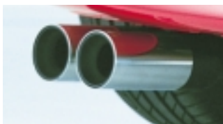
Abt Endschalldämpfer Doppelrohr, Edelstahl, Ø ca. 76 mm, (nur für Frontantrieb).
