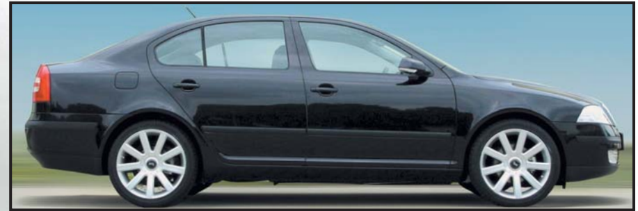
Abt Octavia mit Fahrwerksfedern und Opus Sportfelge Performance IV (8,0 x 18 Zoll)
